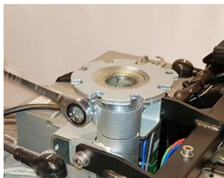
Skru kontraskruen løs. Anvend ringgaffelnøgle, 17 mm.
