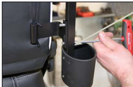
Fastspænd stokkeholderen med to skruer. NV 6mm.
