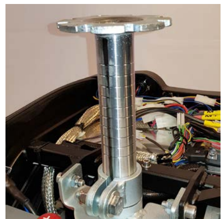
Juster sædestolpen til ønsket position. Sædestolpen er markeret med en ring, for hver centimeter.
