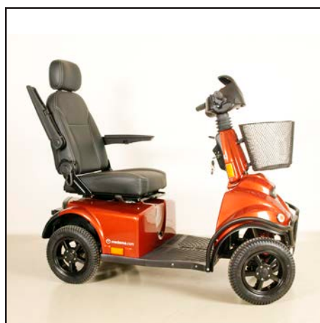
Sluk Mini Crosseren, vip styrstammen op, drej sædet og vip armlænet op.
