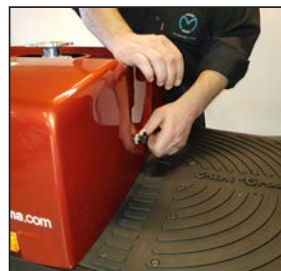
Afmonter fingerskruen og løft bagskærmen af.
