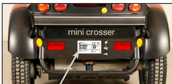
Serienummerskiltets placering på køretøjet.
