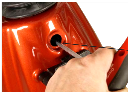
Justering af styrets højde.
