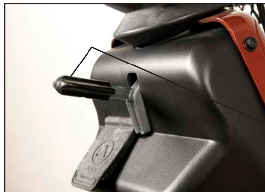
Justering af styrets hældning.
