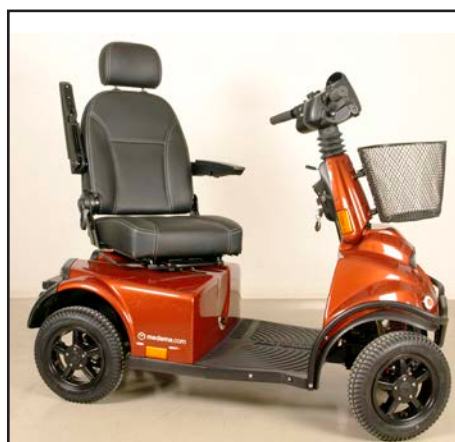
Sluk Mini Crosseren, vip styrstammen op, drej sædet og vip armlænet op.
