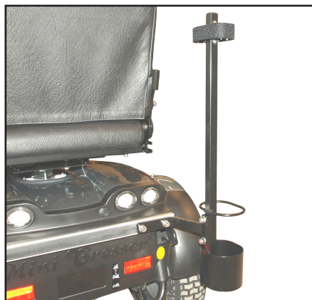
Tilpas liste i længde. Montér stokkeholderen i C-skinnen. Montér proppen igen.
