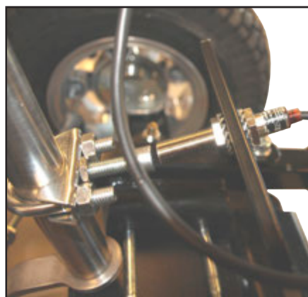
U-bøjle med rørbeslag og skrue monteres på styrstammen. Bemærk afstand til magnet skal være ca. 3 mm.
