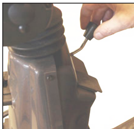
Tag plasthåndtaget af "Udløser for gasfjeder"
