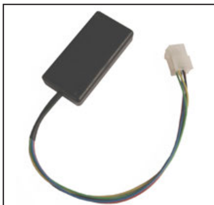
Boksen med tyverialarm, hældningsalarm og temperaturføler.
