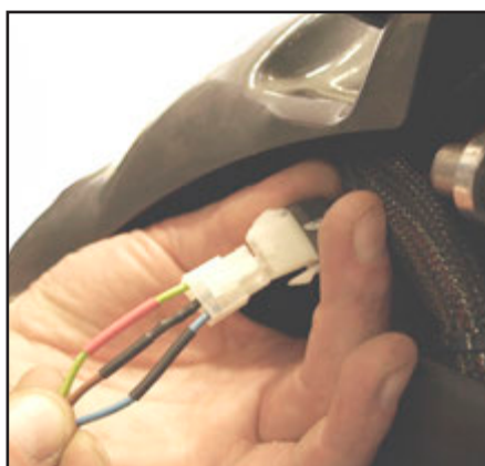
Kablet til fodgassen trækkes igennem hullet og op ved styrstammen. Det medfølgende stik monteres som vist ovenfor. Scooterens stik (nr. 4) til fodgas trækkes frem (ligger under forskærmen), og monteres med fodgassen.
