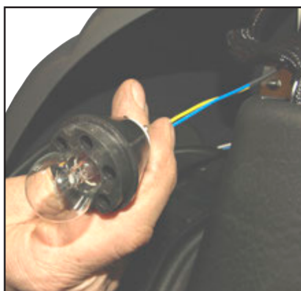
På 4W kan man, løsne pæren og trække den ud til udskiftning, uden at afmontere skærmen.
