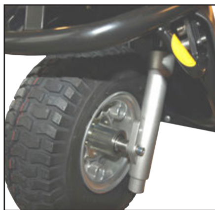
Afmontér forhjulet. Se evt. afsnittet om hjulskift.
