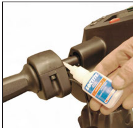
Brug loctite 406 med montering af gashåndtaget.
