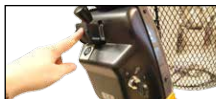
Ladestik forbindes til 3-polet stik på styrcammen. Ladestikket er placeret under beskyttelsespladen.
