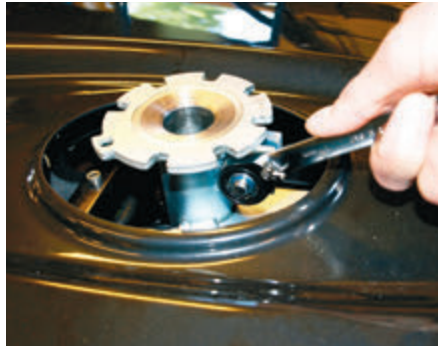
Skru kontraskruen løs. Anvend ringgaffelnøgle, 17 mm.
