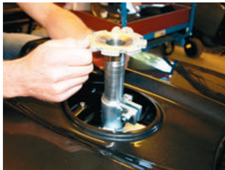
Juster sædestolpen til ønsket position. Sædestolpen er markeret med en ring, for hver centimeter.
