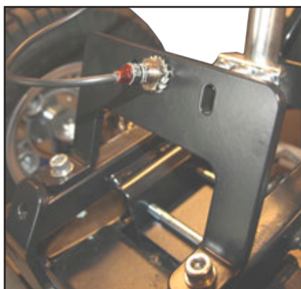
Beslaget monteres på bundramme i de forborede huller.
