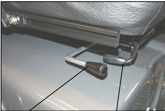
Udløserhåndtag for sædedrej. Udløserhåndtag for sæde frem/tilbage.
