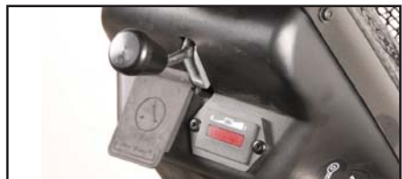
Ladestik forbindes til 3-polet stik på styrstammen. Ladestikket er placeret under beskyttelsespladen.
