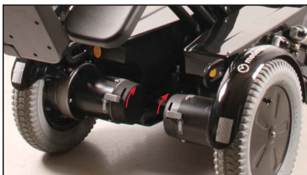
Normal position for kørsel vist på billedet. Vip håndtagene op for at frikoble. ALTID på begge sider.
