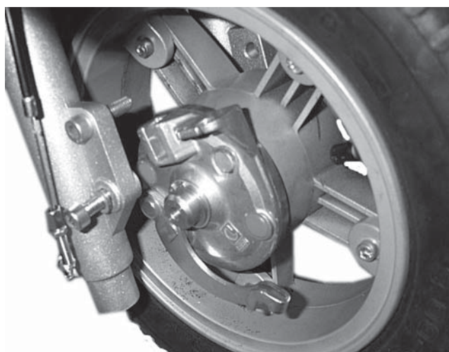
Figur 19 Montering af forhjul. Vær opmærksom på at bremse kaliber placeres i stopskruen øverst.
