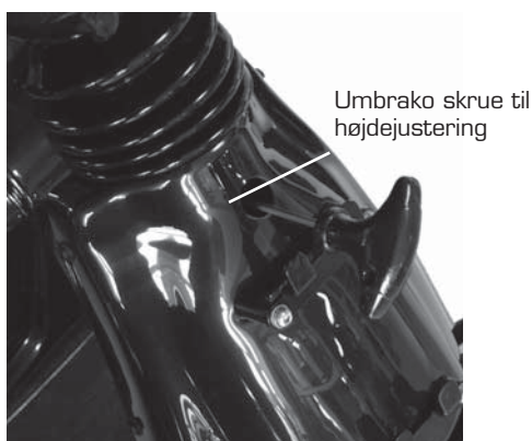
Figur 12 B Justering af styrets højde. Gældende både for 3W og 4W
