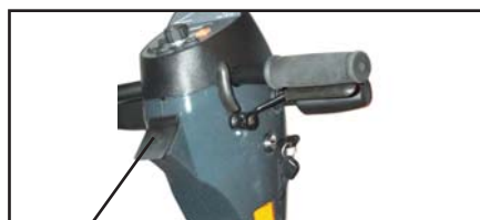
Ladestik forbindes til 3-polet stik på styrestammen. Ladestikket er placeret under beskyttelsespladen.
