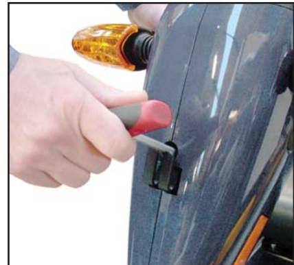
Justering af styrets højde.
