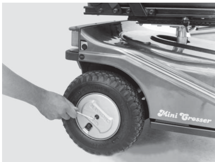
Figur 11 Hjulopslen tages af. Dette gøres ved at demontere skruen i midten af hjulet.
