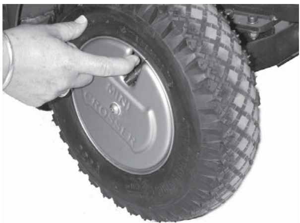
Figur 13 Hjulcapslen tages af. Dette gøres ved at trække hjulkapslen af ved ventilen.
