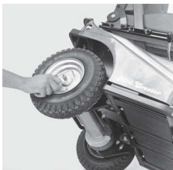
Figur 12 På dette billede ses de 3 skruer som skal af. Derefter kan hjulet tages af. Ved genmontering skal fjederskiverne monteres mellem hjulfælg og skrue. Skrueerne skal spændes godt til.
