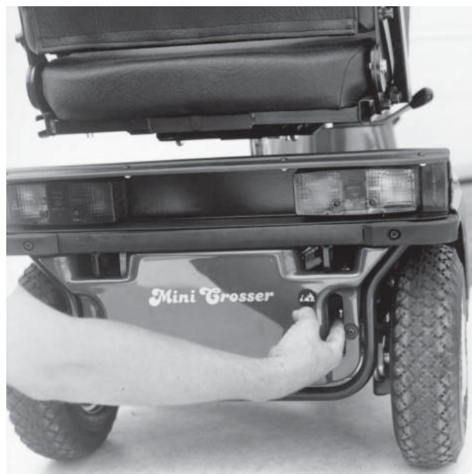
Figur 18 Skub håndtaget ned ved frikobling, og køretøjet kan skubbes. Skub håndtaget op for aktivering af motor (Standardstilling). Håndtaget skal kun ned, når køretøjet skal skubbes. Når bugsering er tilendebragt, skubbes frikoblingshåndtaget op igen. Nu er køretøjet bremsat og kan køre normalt.
