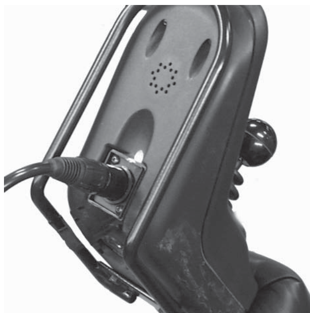
Figur 17 Når stikket ved opladeren skal i køretøjet, skal den hvide streg vende opad.
