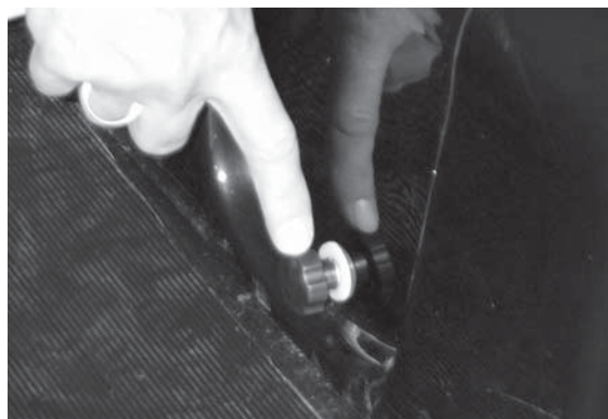
Figur 6 Fingerskruen på forsiden af bagskærmen drejes imod urets retning og tages helt af.
