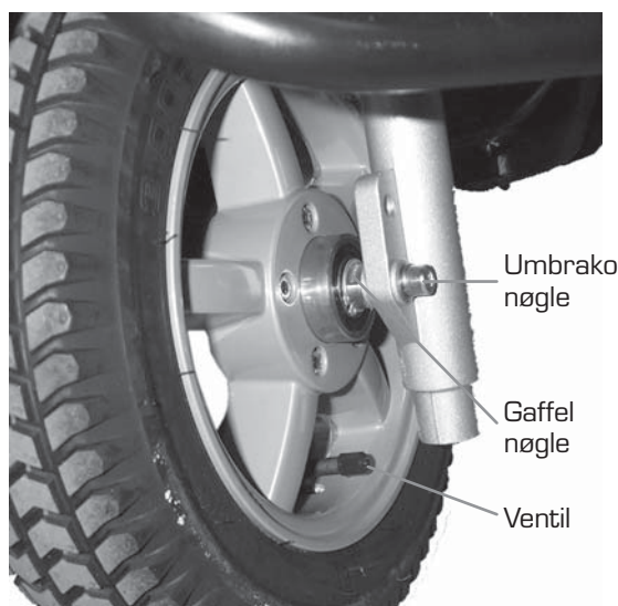
Figur 16 Fjern monteringsbolten med 17 mm gaffel og en umbrako nøgle 6 mm.
