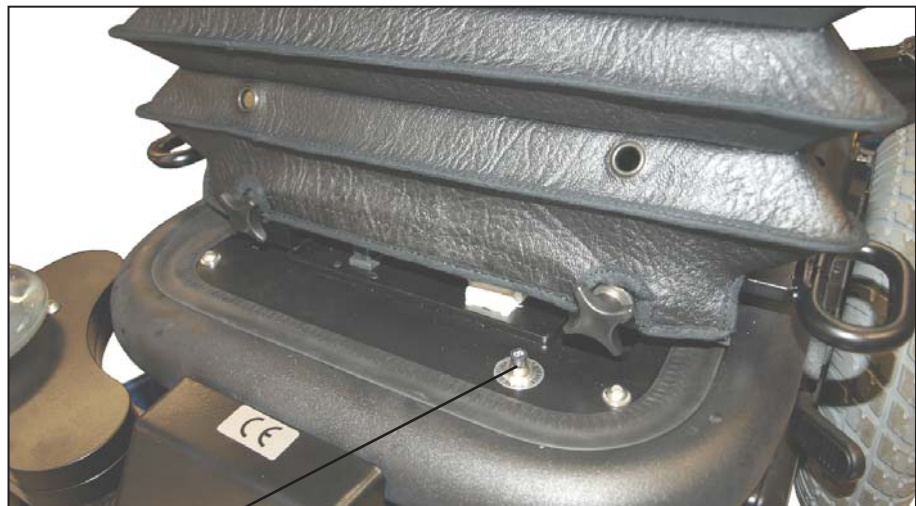
Her sidder termosikringen.
