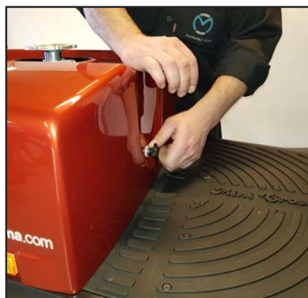
Afmontér fingerskruen og løft bagskærmen af.
