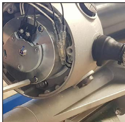
Montér magnetbremsen. Sørg for at ingen kabler kommer i klemme. Frikoblingshåndtaget skal vende som da den blev afmonteret.
