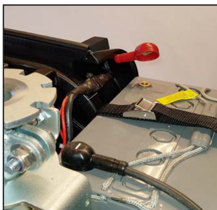
Af sikkerhedshensyn afmonteres en pol på én af batterierne.
