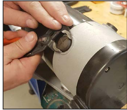
Brug en tang til at løsne låget ind til kulholderen.
