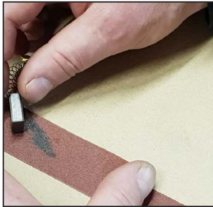
Slib kullet ganske lidt, evt. på et stykke fint smergellærred.
