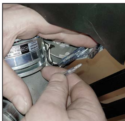
Afmontér de fire stik, og magnetbremsen er fri.
