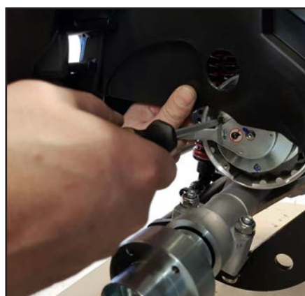
Afmontér magnetbremsen med de 3 skruer. De har alle fået locktite ved montage.
