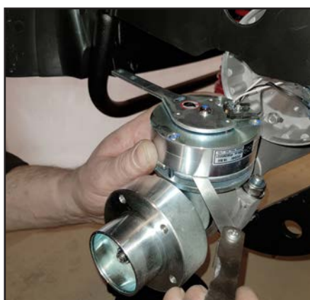
Kontrollér afstanden til magneten. Hvis den er større end 0,35 mm, er den slidt for meget og skal skiftes. En ny har en afstand på 0,15 mm.
