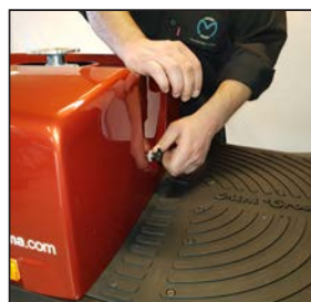
Afmonter fingerskruen og løft bagskærmen af.
