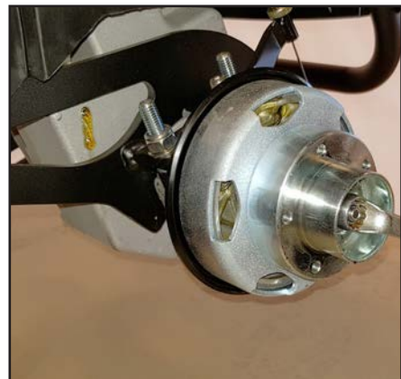
Afmontér afdækningen. (17 nøgle)
