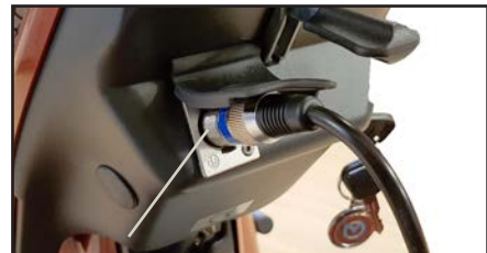
Ladestik forbindes til 3-polet stik på styrcammen. Ladestikket er placeret under beskyttelsespladen.
