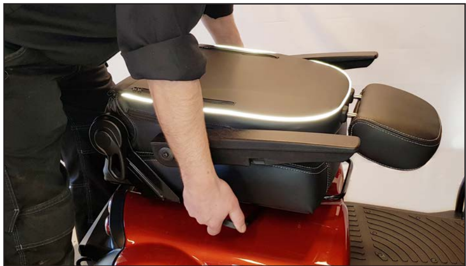
Udløs håndtaget så sædet kan drejes. Sædet løftes op af sæderøret.
